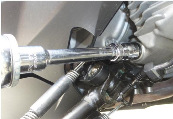
4. Ölfilter am Motorflansch ausbauen, nur **200 ml** Altöl, 76mmØ 12 Rillen
