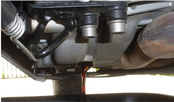
3. Ölsieb Schraube ausbauen, nur **2400 ml** Altöl, **SW 17mm**
